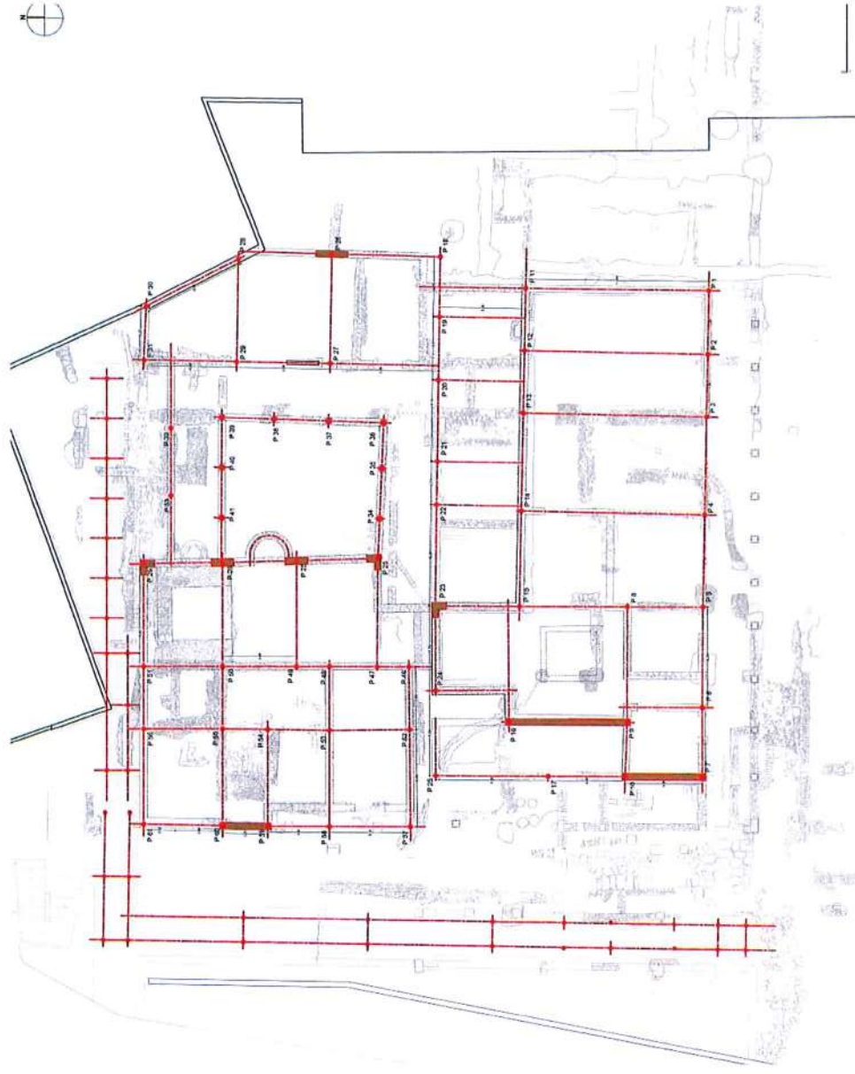
MICROESTACAS E REFORÇOS METÁLICOS EM AUMENTO PAREDE ESTRUTURAL
